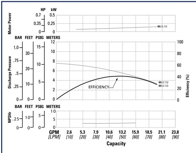
**1/4 HP (0.19 kW) - 60 Hz, 3600rpm**
